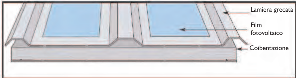
Figura 3. Modulo fotovoltaico non convenzionale consistente in strato metallico, pannello di coibentazione termica e film fotovoltaico
